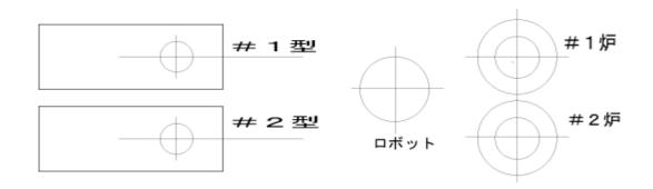
・走行式注湯ロボットを選定の場合(炉:多数、鋳造機:多数)
